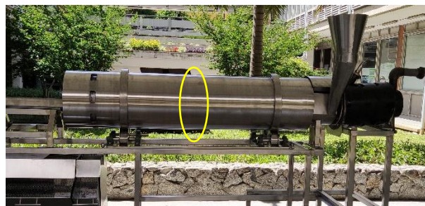
Figura 5. Ubicación del sistema de tracción por cadena en tambor rotatorio
