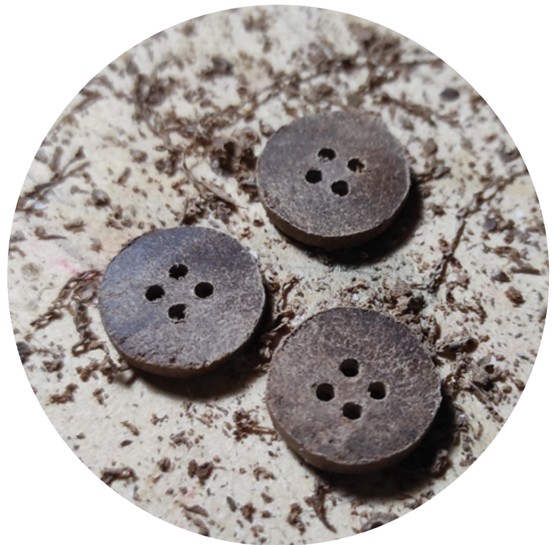
A pesar de ser fabricados a partir de residuos agroindustriales, las propiedades mecánicas de los botones y los apliques para joyería — una de ellas la dureza—, son similares a las de los tradicionales materiales de plástico. Fotos: cortesía Ricardo Mesías.
