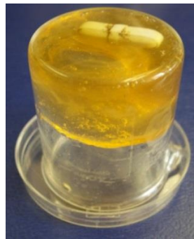
Figura 1. Gel de quitosano modificado autoentrecruzado, producido en una solución de 6% (w/w) del quitosano funcionalizado con aldehído en agua destilada bajo agitación (pH ~ 5.5).
